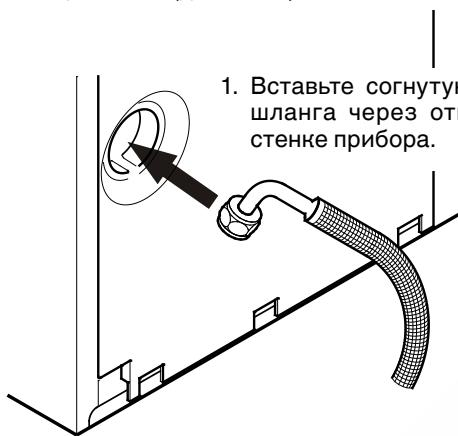
1. Вставьте согнутую под углом часть шланга через отверстие в задней стенке прибора.
