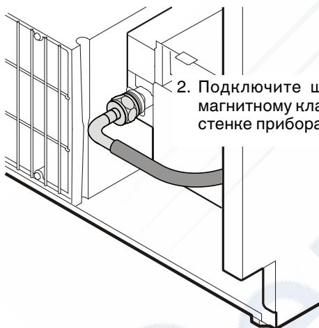
2. Подключите шланг к электромагнитному клапану на передней стенке прибора.
